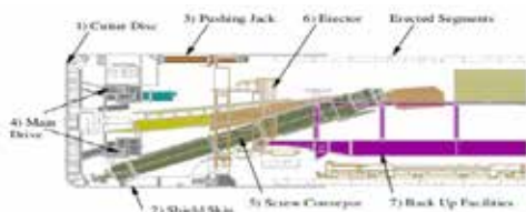
ภาพที่ 3 แสดงตัวอย่างส่วนประกอบของหัวเจาะประเภท EPB
