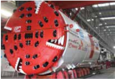
ภาพที่ 1 แสดงหัวเจาะสำหรับชั้นหิน (Hard Rock TBM)
