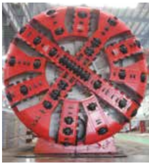
ภาพที่ 2 แสดงหัวเจาะสำหรับชั้นดินอ่อน (Soft Ground TBM)
