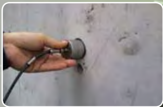
รูปแสดงการทดสอบ Ultrasonic Pulse Velocity Test
