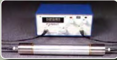
Ultrasonic Test equipment (PUNDIT)
