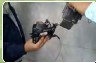
รูปแสดงการทดสอบ Impact Echo Test
